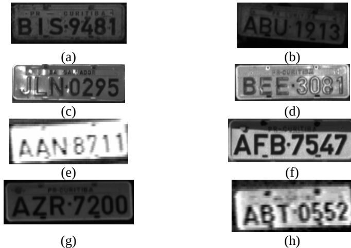
Figura 1. Exemplos dos diferentes agentes naturais que dificultam o processo de segmentação dos caracteres. Todas as imagens são de placas com fundo cinza e caracteres em preto. (a)-(b) sujeira; (c)-(d) reflexo; (e) iluminação natural alta; (f) iluminação natural parcial; (g) iluminação natural baixa; (h) efeito borrão.
