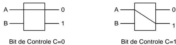
Figura 5. Elemento de Chaveamento.
