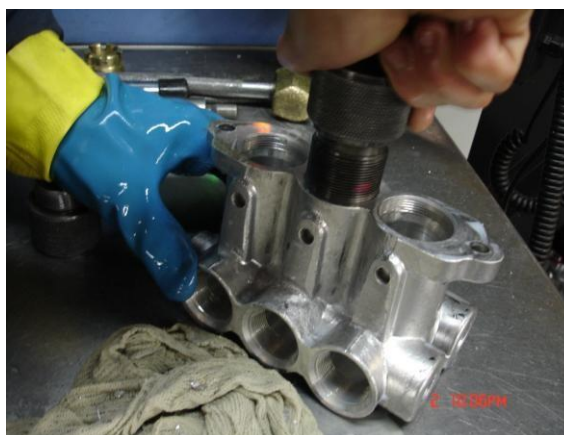
Figura 25: Teste de gabarito ( Poka-Yoke )
